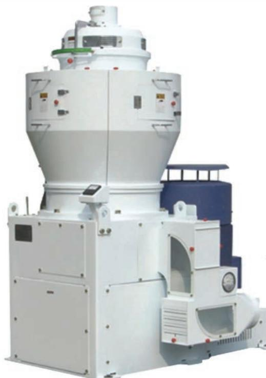
Агрегаты для шлифования модель МПМЛS46 предназначены для окончательного удаления с поверхности зерен оставшихся после шелушения оболочек, а также для обработки крупы до установленной формы и требуемого внешнего вида.
