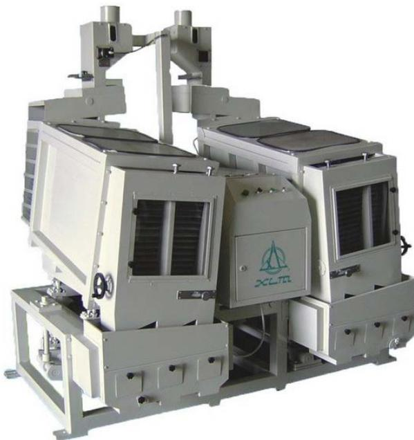
Падди-сепаратор модель: MGCZ60\*20\*2 предназначен для сепарации (разделения) шелушенного и нешелушенного зерна перед дальнейшей переработкой его в крупу.
